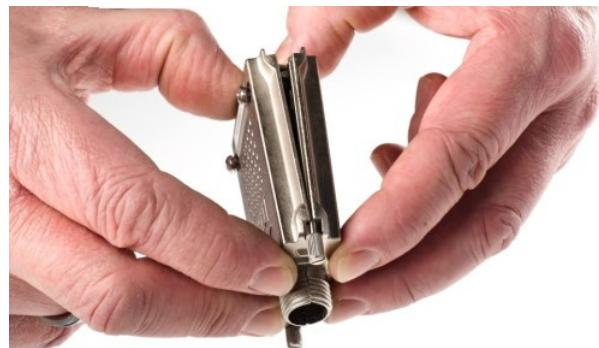
ACC/DSUBM-xxx: Deckel in einem kleinen Winkel ansetzen
