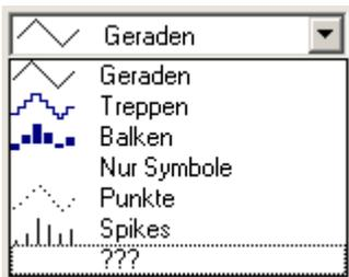
Darstellung der Samples. Normalerweise werden die Samples durch linear interpolierten *Geraden* dargestellt. Alternativ finden Sie in der nachfolgenden Liste weitere Darstellungsmöglichkeiten.
