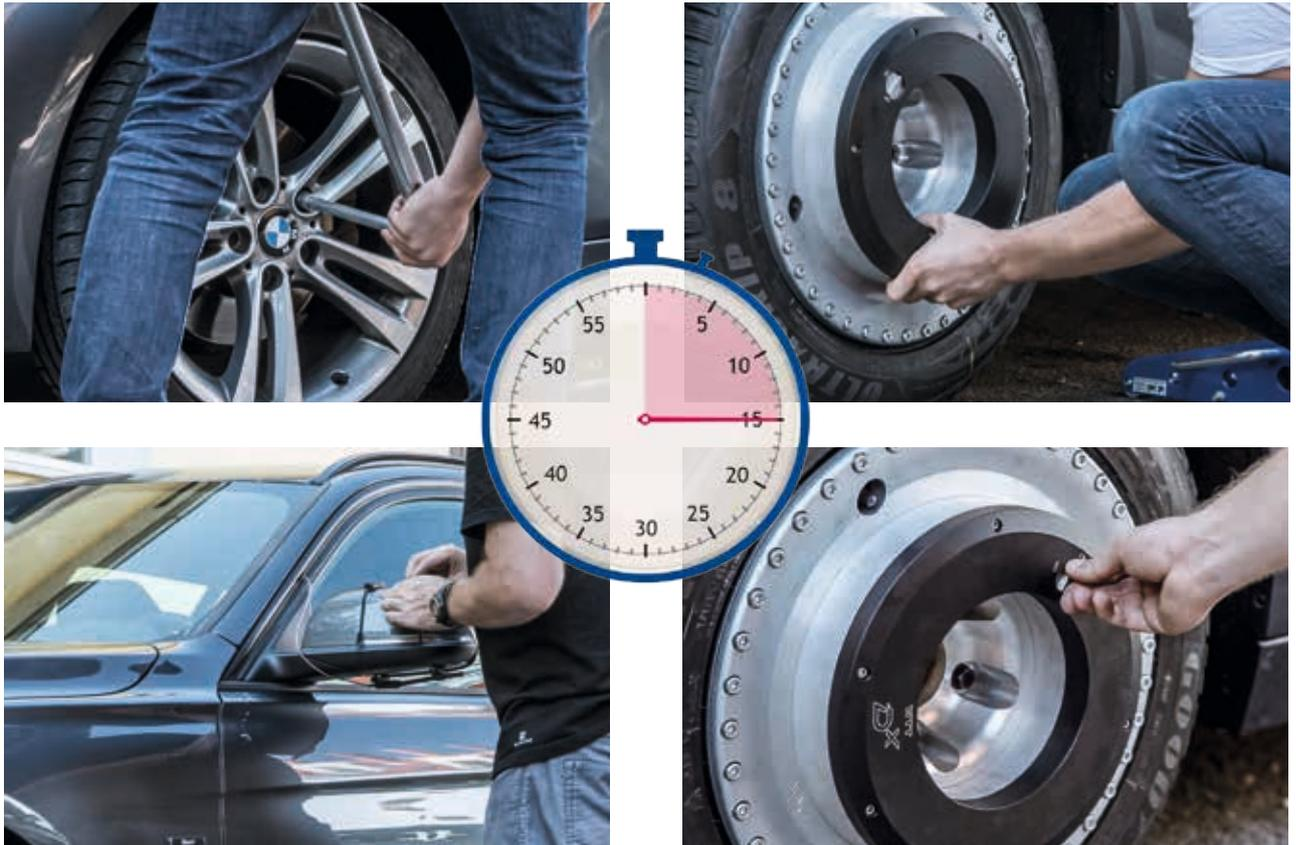
“我们的车轮扭矩传感器为客户提供高精度车轮扭矩测量，一直以来，我们都致力于使传感器安装更简单便捷。通过集成标准产品-D<sup>x</sup>遥测单元，可实现测量数据的同步采集和无线传输，很好地保证了信号质量。”
